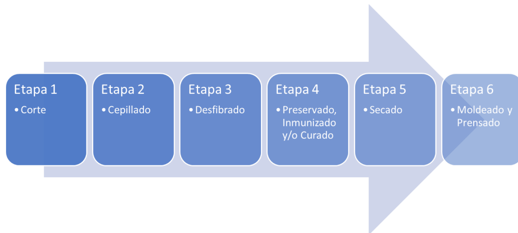
Figura 12. Etapas del proceso de fabricación GLG alta densidad.
