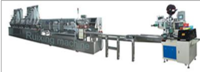
Imagen 2. Máquina para producción de jabón en papel qx-80
