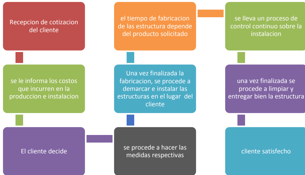
Figura 7. Procedimiento de producción de estructura metálica.
