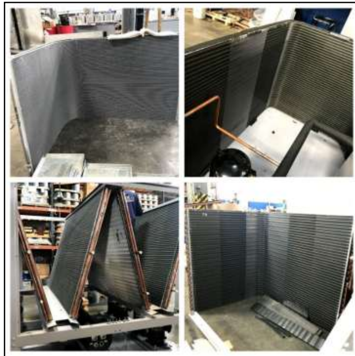
Figura 7 Condensadores equipos de climatización
