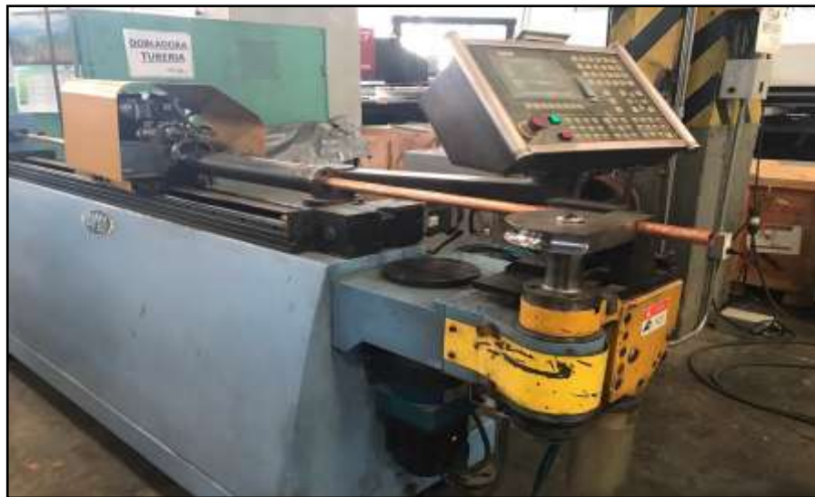
Figura 42 Tubería de 7/8 para doblar en la dobladora 3D.
