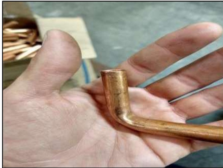
Figura 28 Puente con abolladura en la curva.
