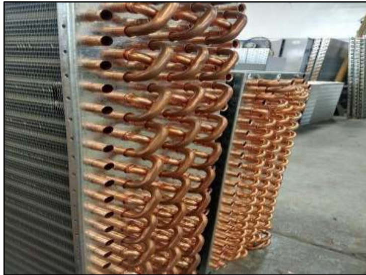
Figura 21 Puentes de tuberías de cobre
