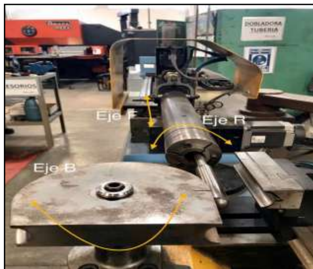
Figura 41 Ejes de movimiento de la dobladora 3D.
