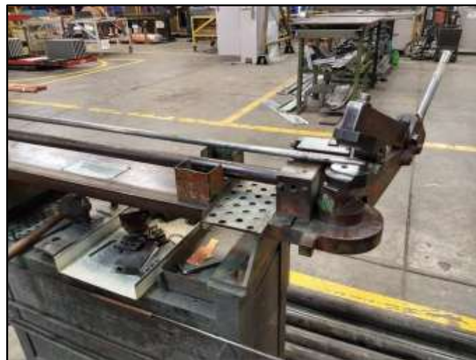
Figura 20 Máquina dobladora fija
