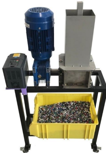
Figura 52. Greenmaker – Trituradora de plástico Precious Plastic.
