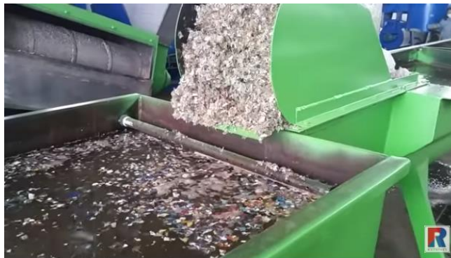
Figura 15. Línea de lavado completo en frío para PET.
