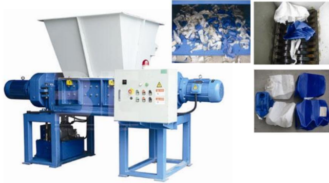
Figura 49. Trituradora de doble eje.
