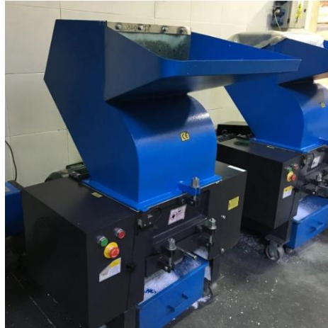
Figura 53. Molino triturador para plásticos, botellas PET.
