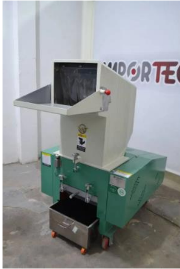
Figura 51. Molino para PET, marca WENSUI VGY 15.
