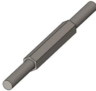
Figura 26. Vista isométrica, eje de transmisión de potencia.
